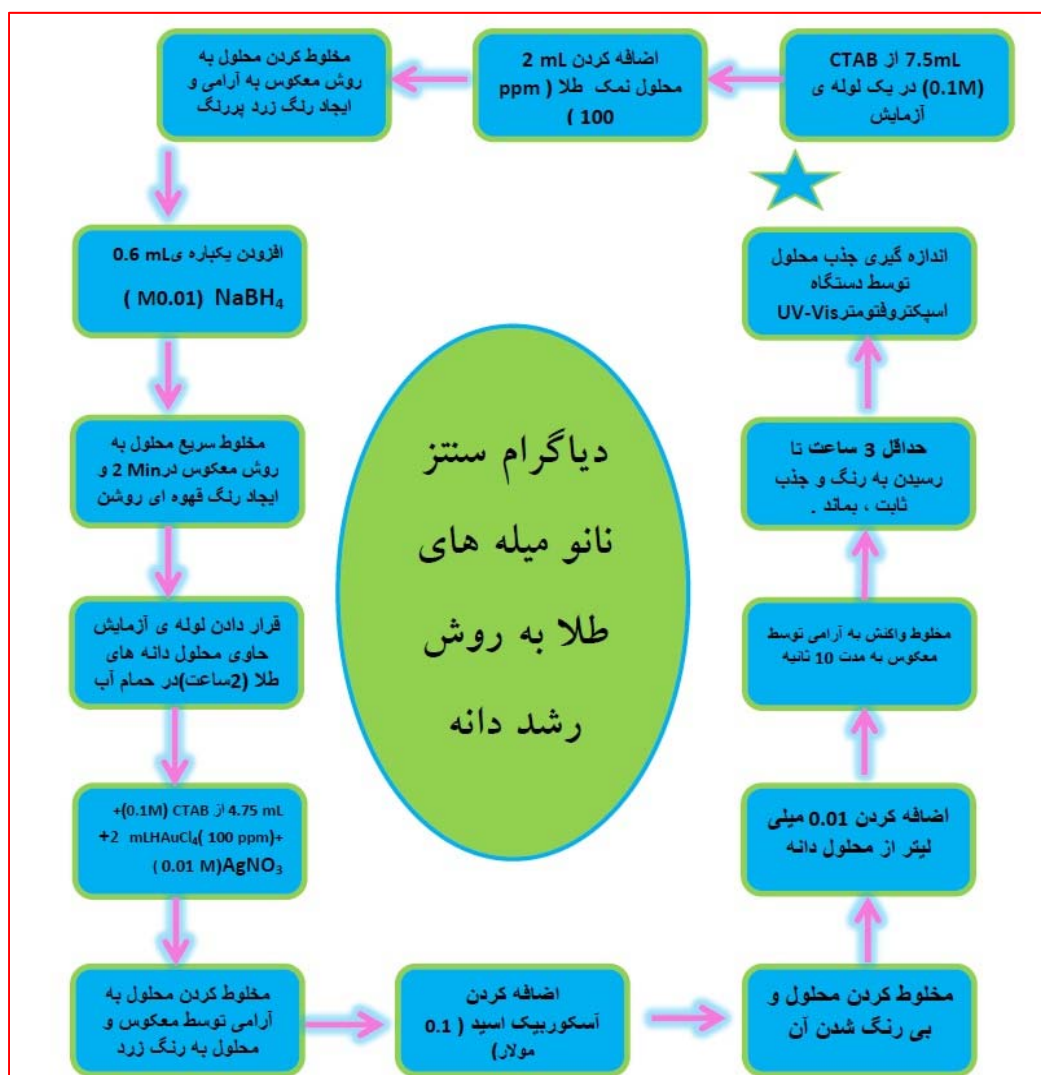
شکل ۷: ب - شماتیک سنتز نانو میله های طلا در این پژوهش
